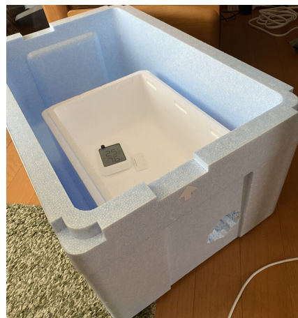
図 9 試作したプロジェクター用耐熱容器
