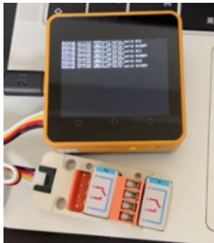
図 6 NNEPS Ver.B の電源制御プラグ。M5Stack Core2 for AWS とリレーモジュールで構成。
