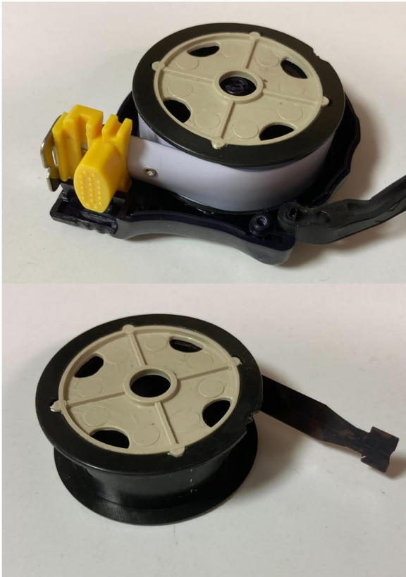
図 6 メジャーの内部構造
