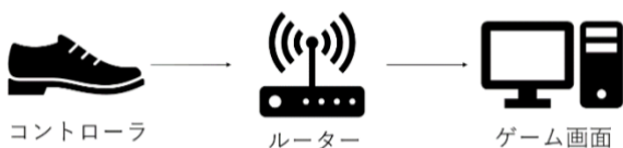
図 8 SRIPY のシステム構成
