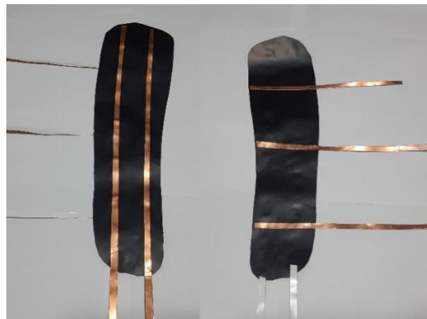
図 9 足底部に設置した圧力感知センサ
