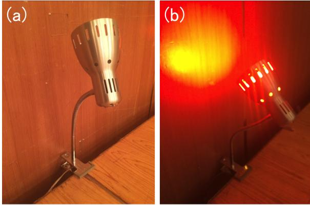
図 1 PICALA の設置に用いたクリップ式電球ソケット. (a) 消灯時, (b) 点灯時
