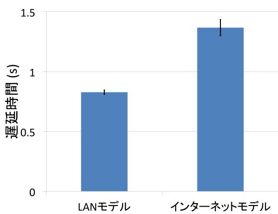
図 5 LAN モデルとインターネットモデルにおける、ボタン押下から照明点灯までの遅延時間の計測結果。エラーバーは標準誤差を示す。
